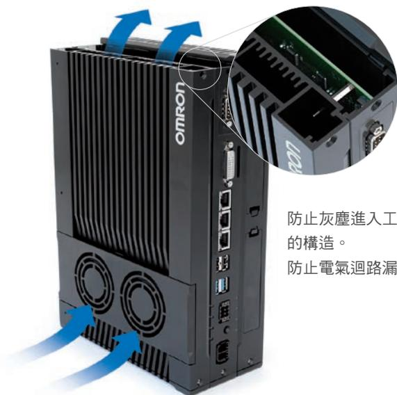
防止灰塵進入工業電腦內部的構造。
