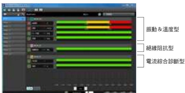
顯示多個馬達的警報狀態。能依時間順序確認馬達狀態的變化。
